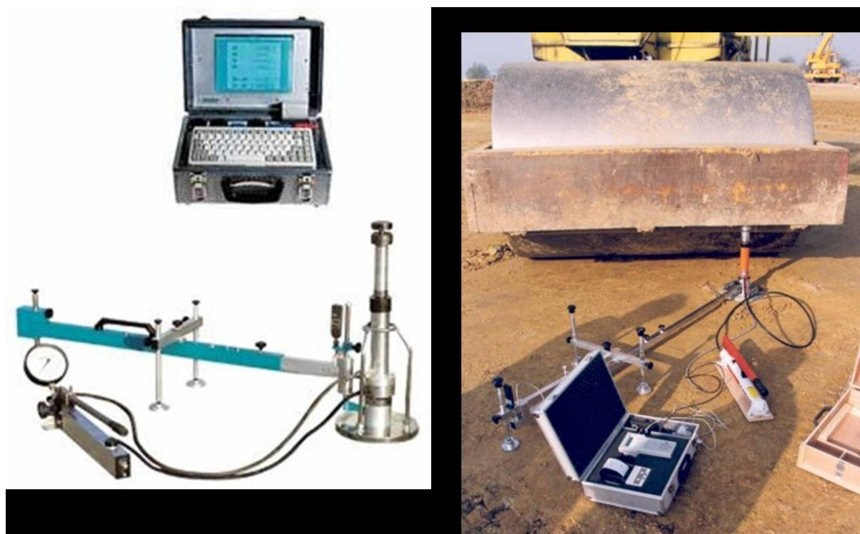
Obrázek 10: Statická zatěžovací zkouška - zařízení ECM-Static
