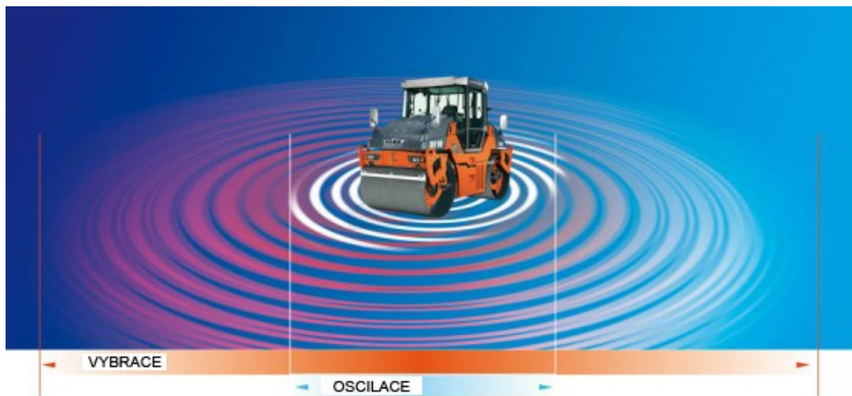
Obrázek 32: Hutnící účinek oscilace a vibrace (zdroj www.hamm.eu )
