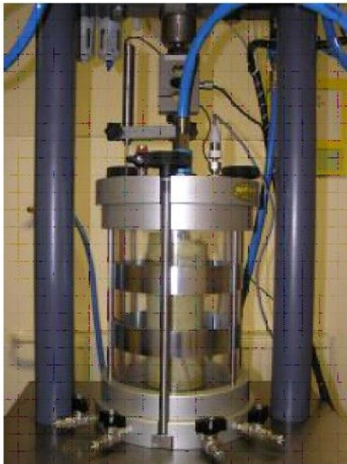
Obrázek 06: Cyklický triaxiální přístroj pro stanovení modulu pružnosti a trvalých deformací vzorků zhutněných nestmelených směsí Ø 100 mm, výšky 200 mm, zrnitosti 0/20
