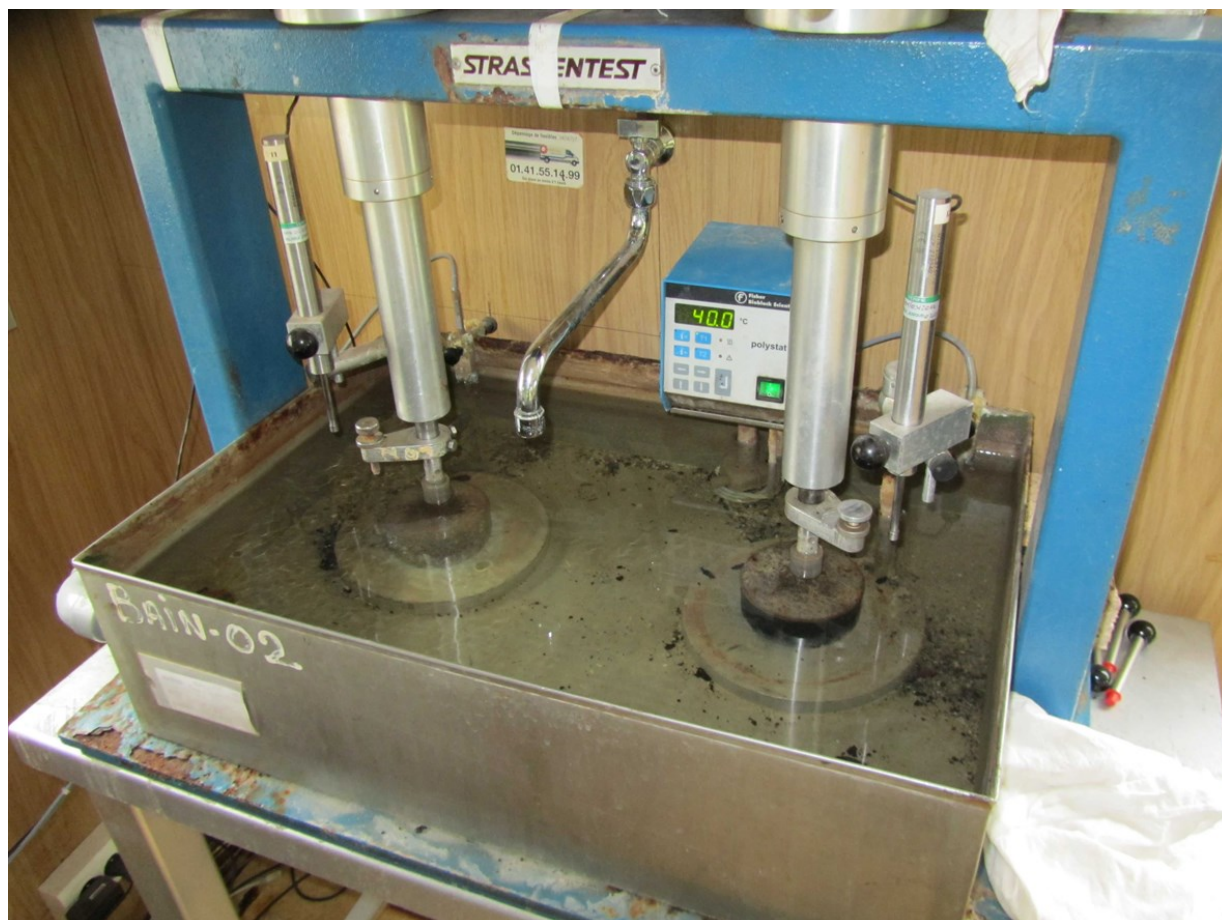
Obrázek 14: Zkouška stanovení čísla tvrdosti
