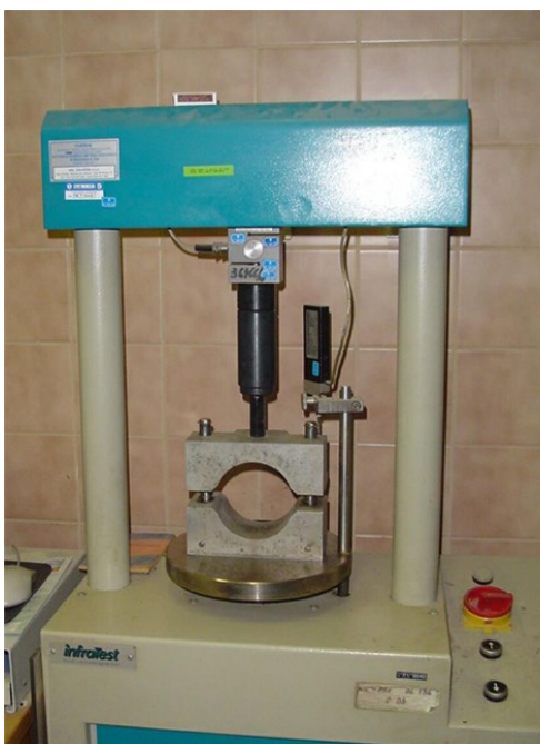
Obrázek 10: Marshallův lis (vlevo) a grafické znázornění definic stability S a přetvoření F (vpravo)
