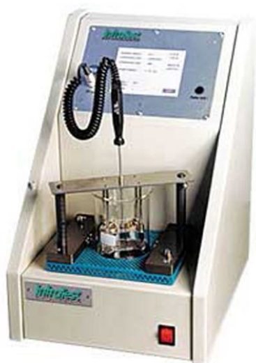
Obrázek 15: Bod měknutí – zkouška kroužek kulička, přístroj a princip zkoušky
