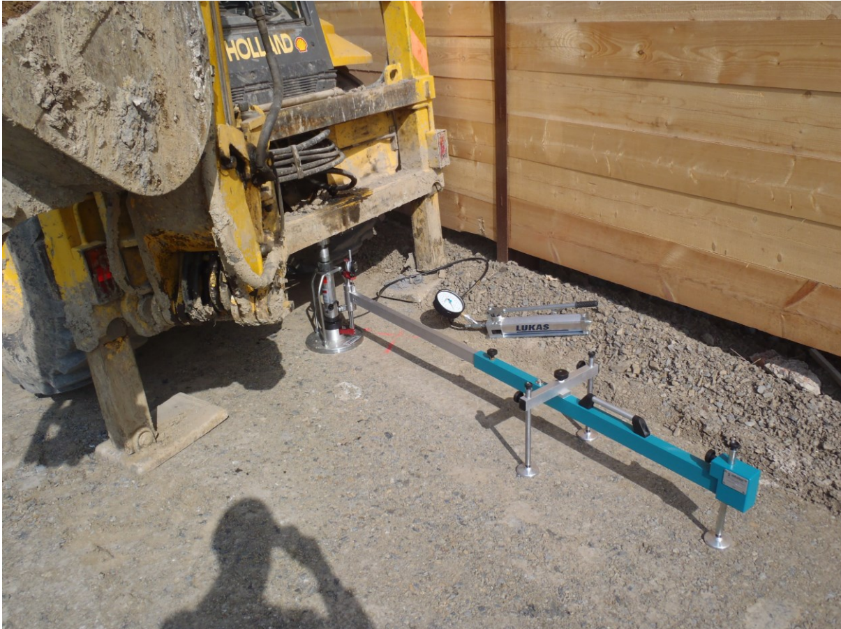
Obrázek 32: Statická zatěžovací zkouška
