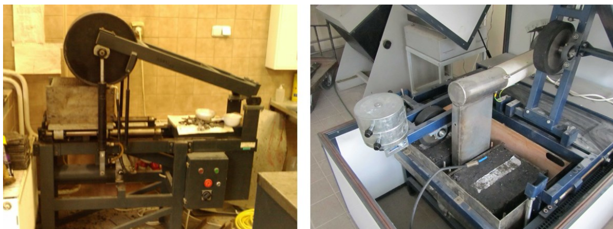
Obrázek 12: Lamelový zhutňovač (vlevo) a tzv. malé zkušební zařízení se dvěma vzorky, s jedním odklopeným kolem s gumovou obručí a druhým připraveným ke zkoušce i se zatížením (vpravo)
