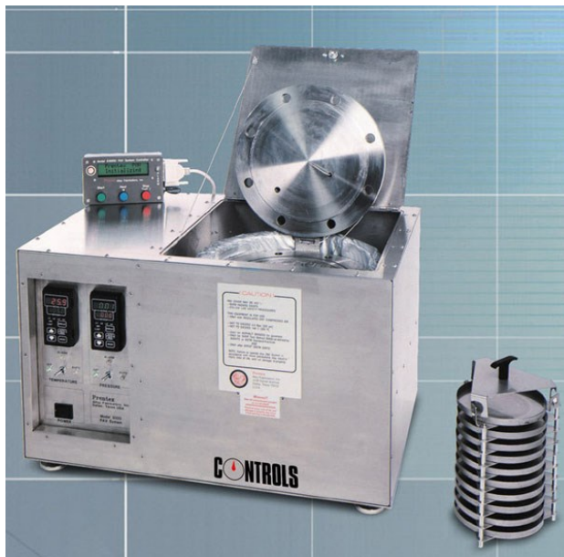
Obrázek 19: Zkouška dlouhodobého stárnutí v přístroji PAV. Přístroj a vzorek.
