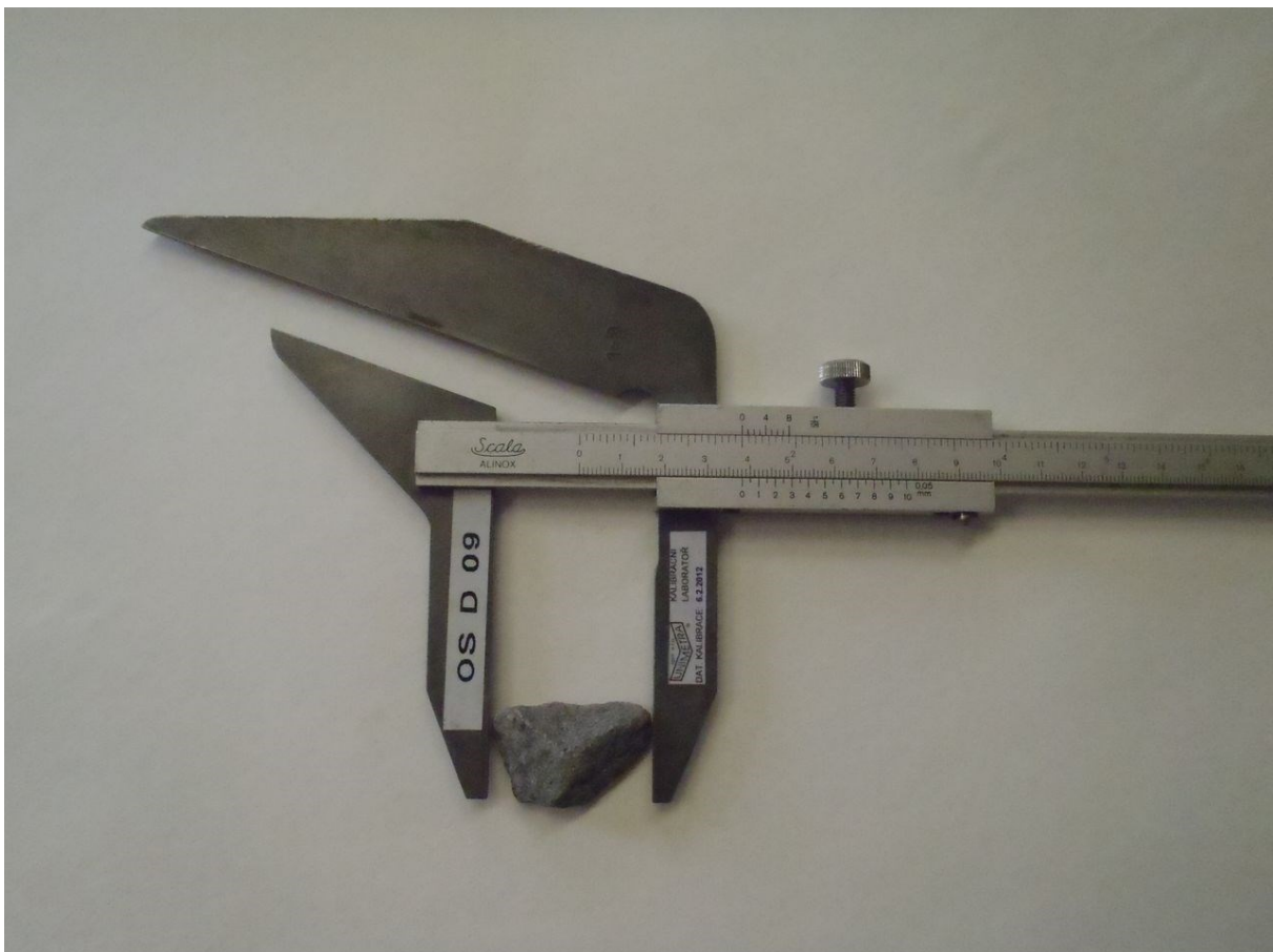
Obrázek 03: Stanovení tvarového indexu – největší rozměr zrna
