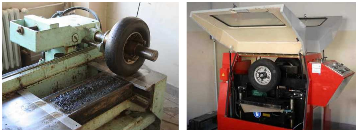
Obrázek 13: Pneumatikový zhutňovač desek (vlevo) a tzv. velké zkušební zařízení (vpravo)
