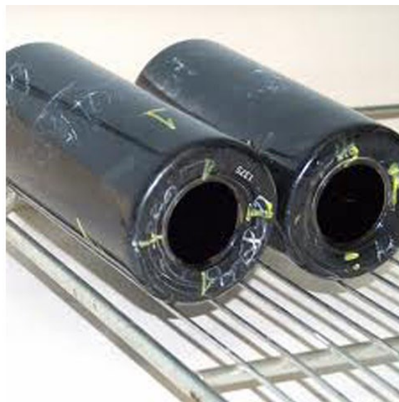
Obrázek 18: Zkouška krátkodobého stárnutí metodou RTFOT. Příklad přístroje a skleněné baňky.
