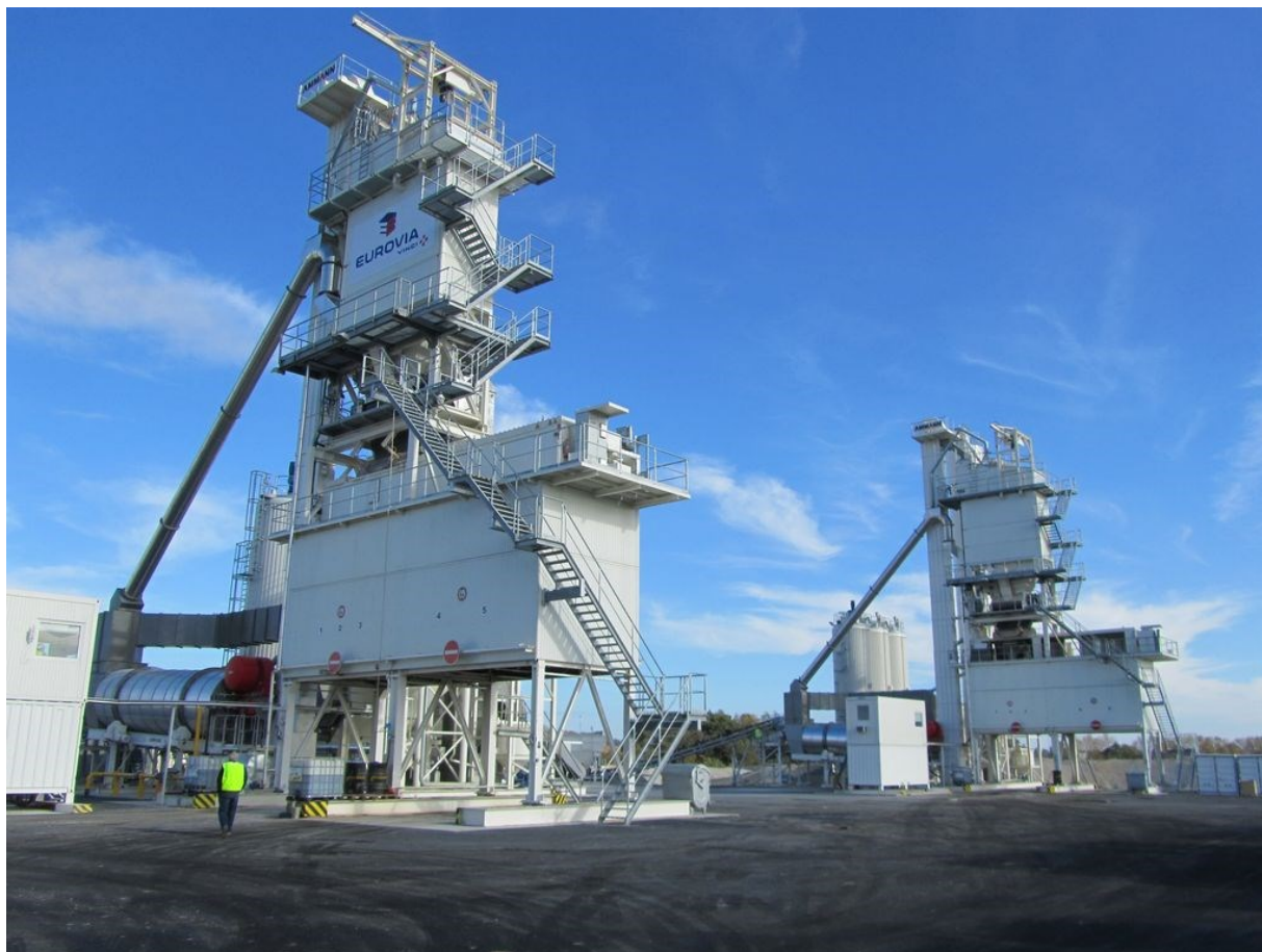
Obrázek 20: Dvě šaržové obalovny Ammann, každá s výkonem 240 t/h
