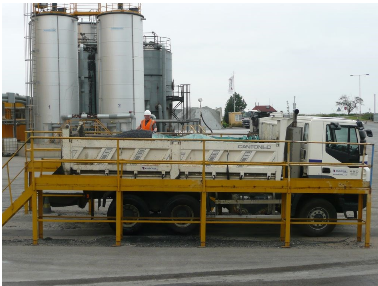
Obrázek 24: Zaplachtování vozidla před přepravou směsi
