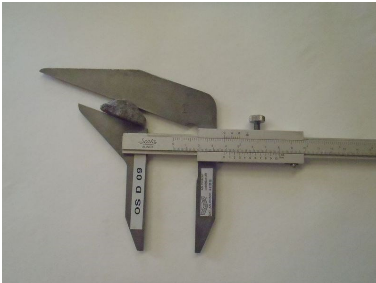
Obrázek 04: Stanovení tvarového indexu – nejmenší rozměr zrna
