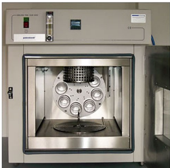
Obrázek 18: Zkouška krátkodobého stárnutí metodou RTFOT. Příklad přístroje a skleněné baňky.
