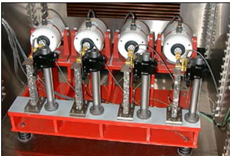
Obrázek 15: Dvoubodová zkouška na komolém klínu
