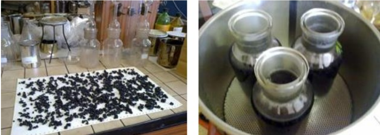
Obrázek 09: Rozdrobení asfaltové směsi s prázdnými pyknometry v pozadí (vlevo) a její vložení do vakuového hrnce (vpravo)
