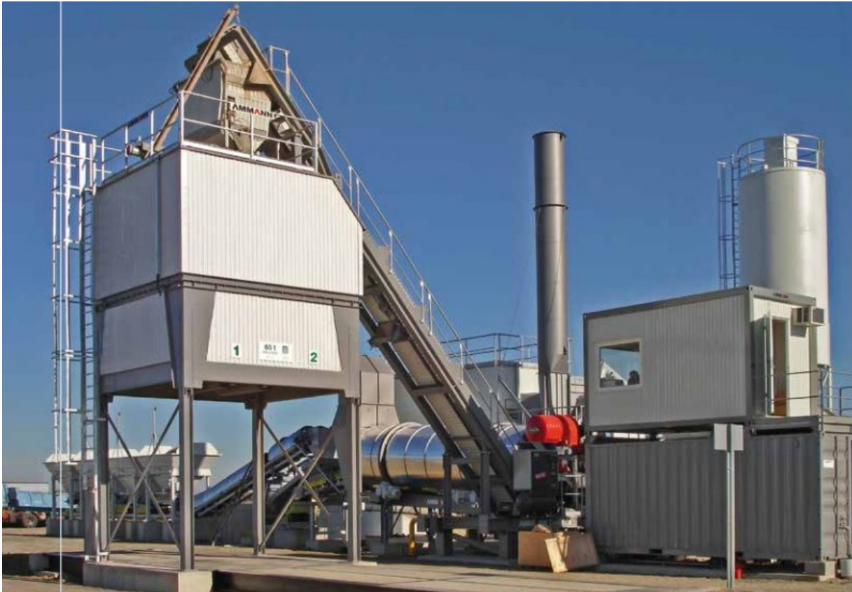
Obrázek 22: Kontinuální obalovna Ammann s výkonem 320 t/h (převzato z www.ammann.com )
