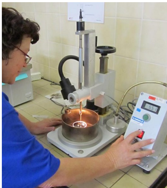
Obrázek 14: Penetrometr při měření penetrace a princip zkoušky
