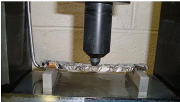
Obrázek 21: Detail zatížení trámečku v přístroji BBR a princip zkoušky.
