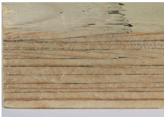
Fig. 3 Połączenie zakładkowe w zewnętrznej warstwie LVL oraz połączenie na wczep klinowy lameli z drewna klejonego
