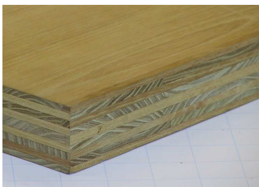
Fig. 6 Sklejka 9-o warstw. (robinia) i zast. sklejki jako poszycie usztywniające ścian szkieletowych
