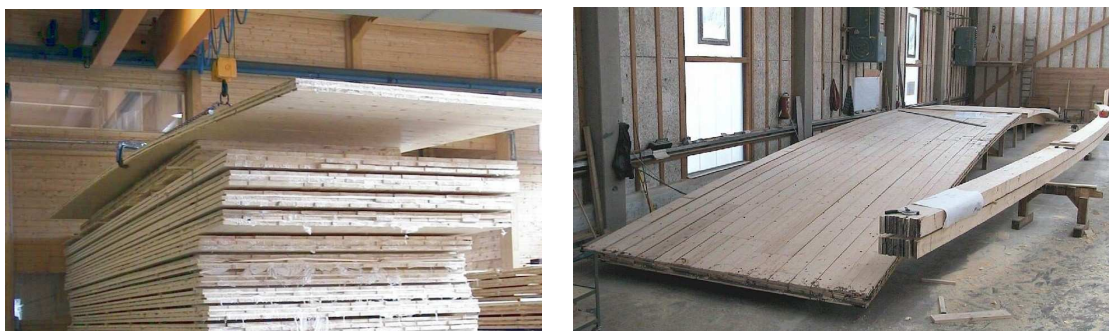
Fig. 16 Płaskie i zakrzywione elementy CLT w czasie produkcji
