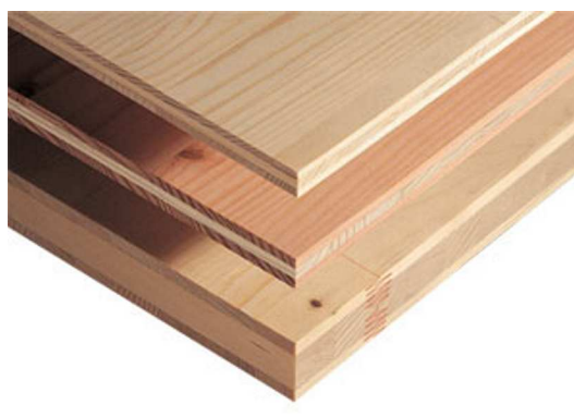
Fig. 4 Połączenia skrzyżowane w CLT i płytach laminowanych
