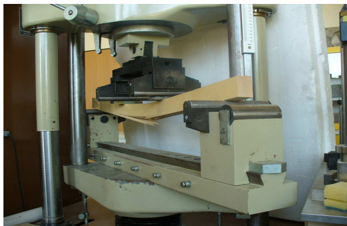
Fig. 5 Próba zginania belki litej
