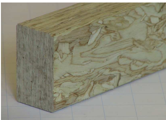
Fig. 4 LSL i ich zastosowanie jako belki
