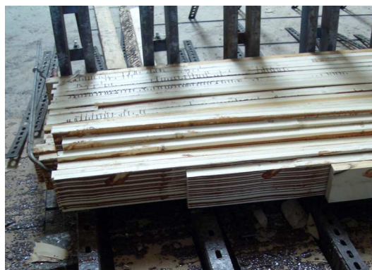
Fig. 2 Zastosowanie klejów i pras przy produkcji glulam
