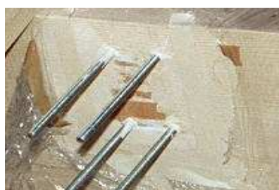
Pręty wklejone (obciążone poprzecznie do ich osi)
