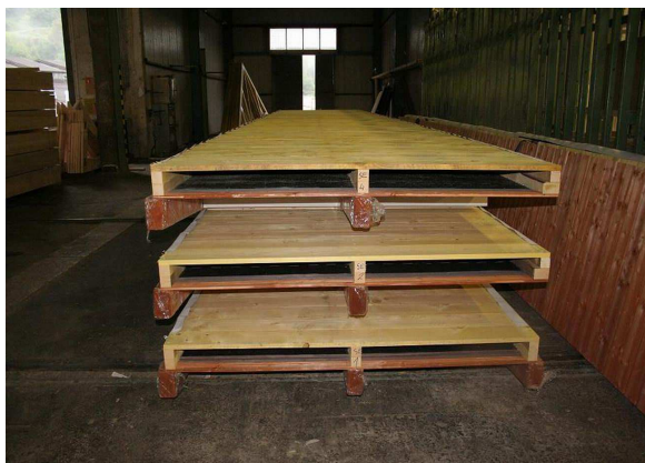
a. Prefabrykowane belki dachowe z pokryciem
