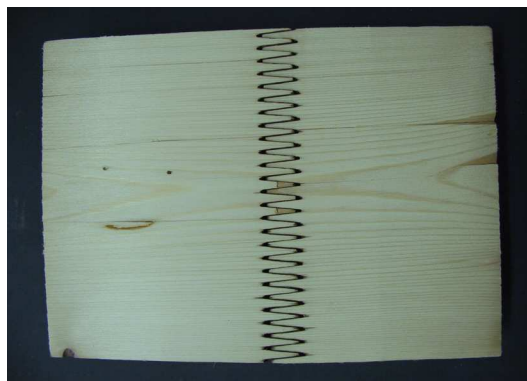
Fig. 3 Połączenie zakładkowe w zewnętrznej warstwie LVL oraz połączenie na wczep klinowy lameli z drewna klejonego
