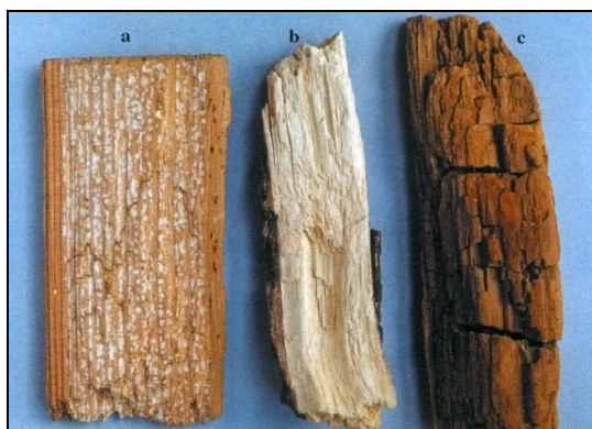
Fig. 2 Rozkład grzybiczy: biały częściowy (a), biały pełny (b), brązowy (c) [2].
