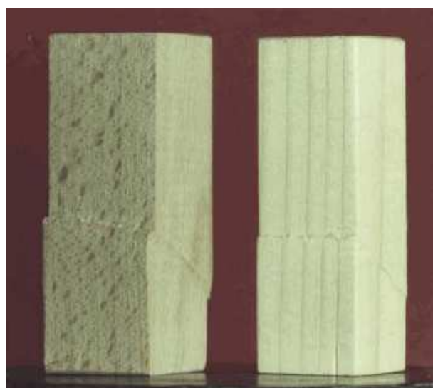
Fig. 3 Mechanizm zniszczenia przy ściskaniu wzdłuż włókien
