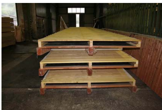
a.) Predpripravené strešné nosníky s opláštením vikierov
