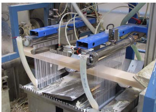
Obr. 2 Aplikovanie lepidla a lisovanie lepeného lamelového dreva
