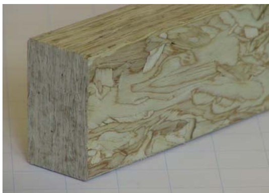
Obr. 4 LSL a jeho použitie ako nosník
