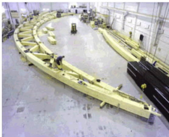
Obr. 15 Výroba jedného oblúka (Zobrazené s povolením Svenskt Limträ AB)
