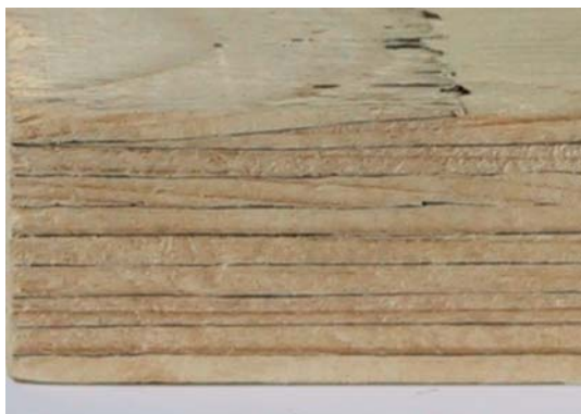
Obr. 3 Pohľad na klinový spoj zboku (vľavo) a zhora (vpravo)
