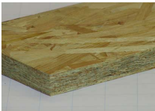
Obr. 3 OSB a jej použitie ako nosný obkladový materiál v stĺpkovej konštrukcii
