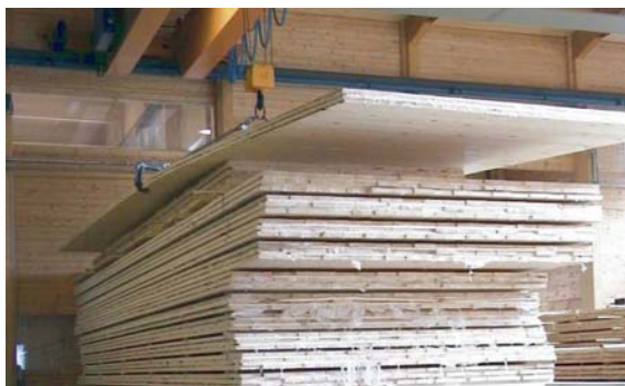
Obr. 16 Rovinné a zakrivené CLT-elementy v procese výroby
