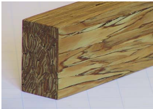
Obr. 5 Parallam a jeho použitie ako ťahaný prút priehradového väzníka
