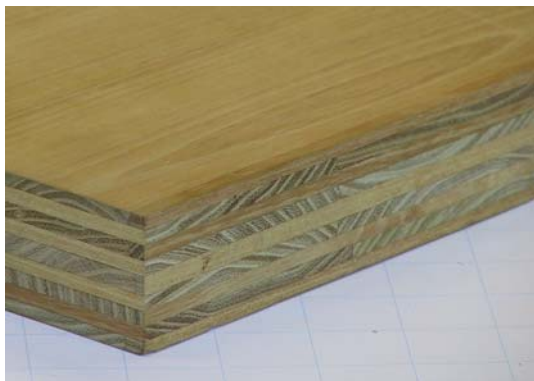
Obr. 6 9-vrstvová agátová preglejka a použitie preglejok ako výstužných prvkov drevostavby
