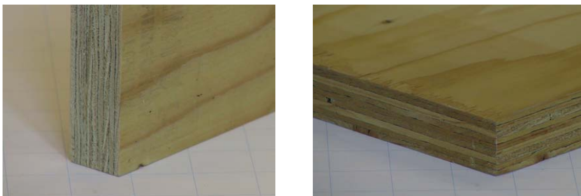
Obr. 8 LVL a LVL s vrstvami v priečnom smere
