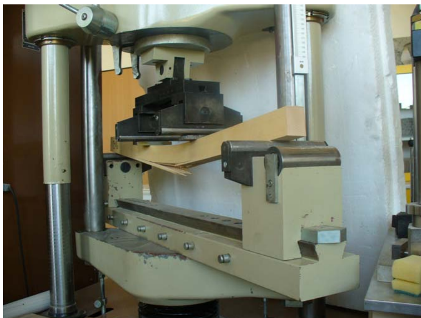
Obr. 5 Ohybová zkouška nosníku z rostlého dřeva
