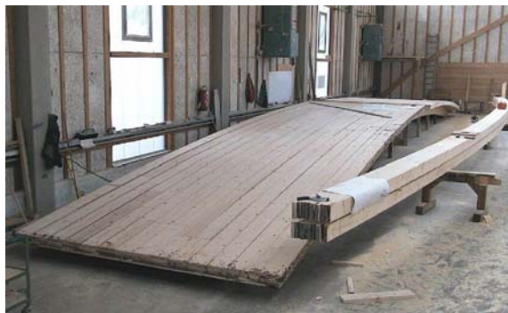
Obr. 16 Rovinné a zakrivené CLT-elementy v procese výroby
