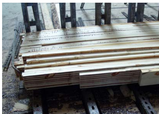
Obr. 2 Aplikovanie lepidla a lisovanie lepeného lamelového dreva
