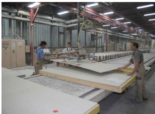
Obr. 3 a.) Príprava stenových panelov vo výrobni b.) Montáž stien na stavbe
