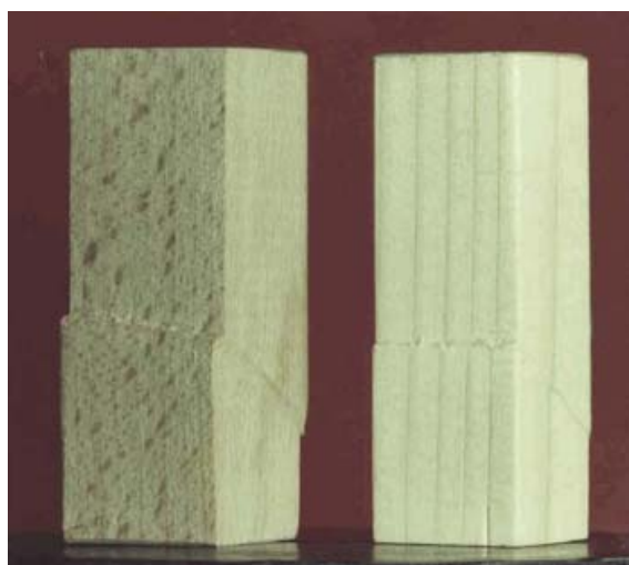
Obr. 3 Způsob porušení dřevěného prvku v tlaku rovnoběžně s vlákny
