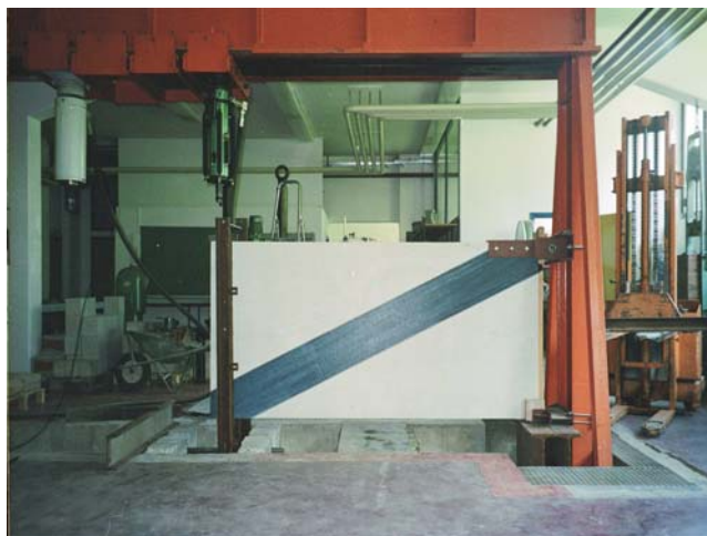
Obr. 11 Skúšanie panelu zosilneného CRFP – lamelami [17], panel je pootočený o 90°
