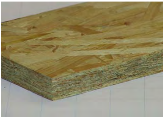
Abb. 6.3 OSB und seine Anwendung als lastabtragendes Beplankungsmaterial in einer Wandscheiben
