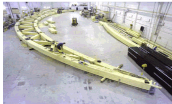
Abb. 5.15 Erzeugung eines Bogens (Photo: Svenskt Limträ AB)
