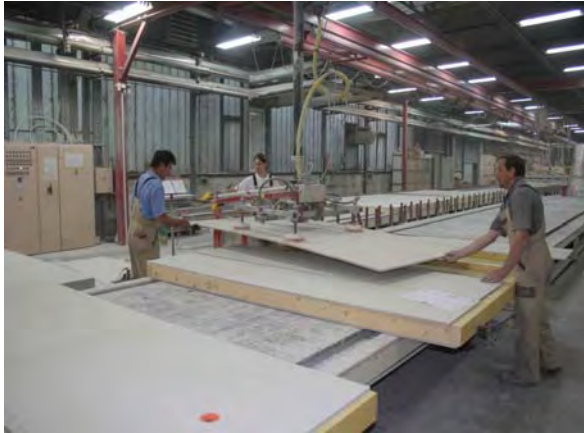
a. Produktion von vorgefertigten Wandelementen in Tafelbauweise
