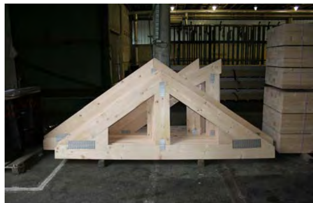
b. vorgefertigte Firstelemente
