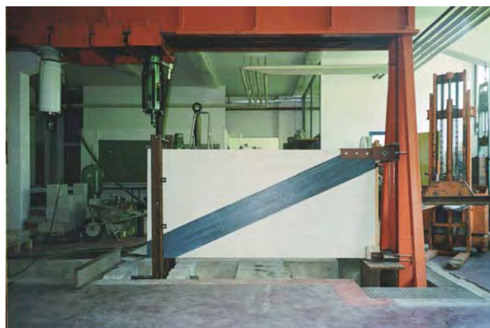
Abb. 13.11 Versuch an einem, um 90° gedrehten, diagonal CFRP-verstärkten Prüfkörper [17],
