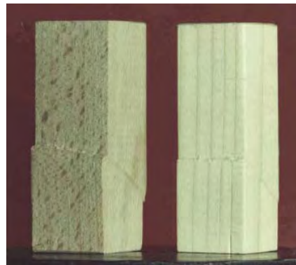
Abb. 9.3 Versagensmechanismus von Holzbauteilen unter Druck
