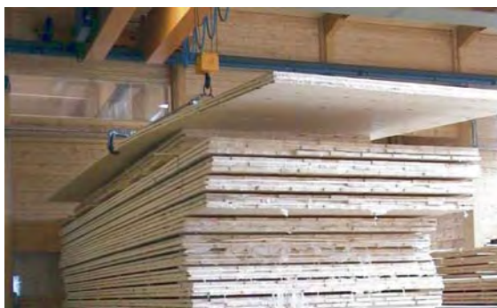
Abb. 6.16 Ebene und gekrümmte CLT- Elemente im Produktionsprozess
