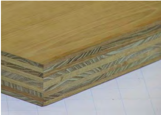
Abb. 6.6 9-lagiges Sperrholz (Robinie) und Verwendung von Sperrholz als Beplankungsmaterial in einer Holzrahmenwandkonstruktion
