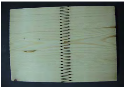
Abb. 10.5 Keilzinkenverbindung einer Brettschichtholzlamelle und geklebtes Rahmeneck
