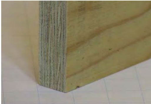
Abb. 6.8 Furnierschichtholz (LVL) mit ausschließlich längsorientierten Lagen und LVL mit abwechseln in Querrichtung orientierten Lagen
