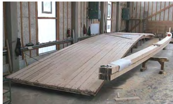
Abb. 6.16 Ebene und gekrümmte CLT- Elemente im Produktionsprozess
