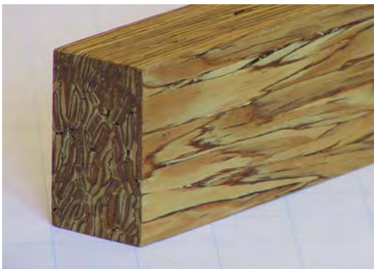
Abb. 6.5 Parallam und seine Verwendungen als stabförmiges Produkt als Zuggurt eines Fachwerks
