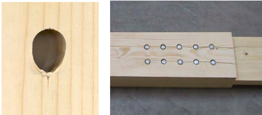
Abb. 10.10 Aufspalten eines Probekörpers im Lochleibungsbereich eines Verbindungsmittels und „Reißverschlusseffekt“ in einem zweireihigen Zuglaschenstoß
