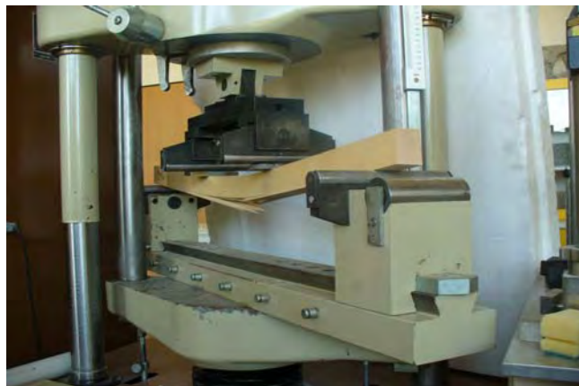
Abb. 9.5 Biegeversuch an Vollholz
