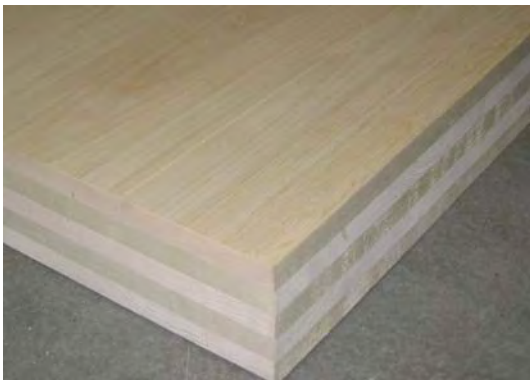
Abb. 4.4 kreuzweise Verklebung von Brettsperrholz und Mehrschichtplatten
