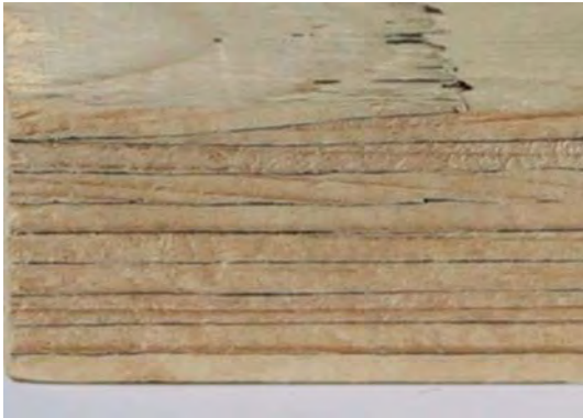
Abb. 4.3 Schäftung in der äußersten Lage eines Furnierschichtholzes (LVL) und Keilzinkenverbindung einer Brettschichtholzlamelle
