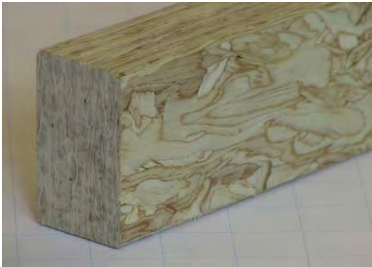
Abb. 6.4 LSL und seine Verwendung als stabförmiges Produkt (Träger)
